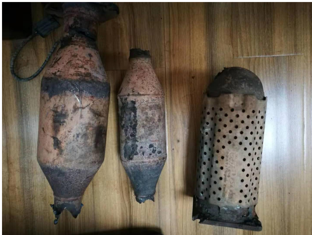
图 3.3-3 本项目拆解的废旧汽车尾气净化器实拍图
